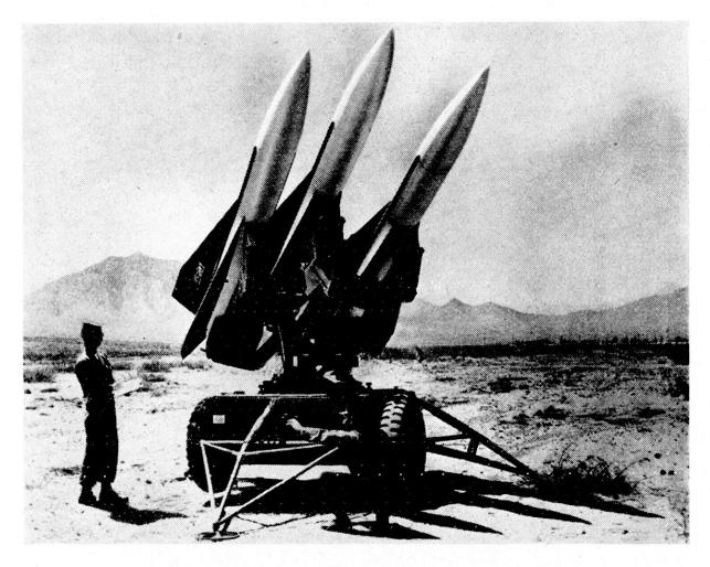
Amerikanische Boden-Luft-Rakete «Hawk» gegen Flugzeuge in unteren Flughöhen, montiert auf einem halben Lastwagen-Fahrgestell. Das Fahrgestell ist lufttransportierbar und die Abschußvorrichtung kann ab Normal-Flugzeug oder Helikoptern betätigt werden. Diese Raketen sind gegen Ende des Fluges fern- und selbstgesteuert Sie dienen zur Ergänzung der Luftabwehr von «Nike»-Batterien.
