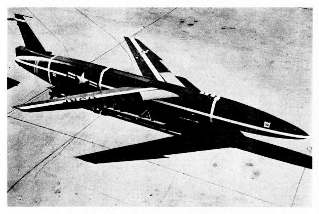
Amerikanisches Interkontinental-Ferngeschoß «Snark», von der Luftwaffe entwickelt. Es handelt sich eigentlich um ein unbemanntes Flugzeug, das astronomisch, also nach den Sternen, gesteuert wird. Das Geschoß bewegt sich innerhalb der Schichten der Erdatmosphäre und hat eine Geschwindigkeit von zirka 0,9 Mach.
