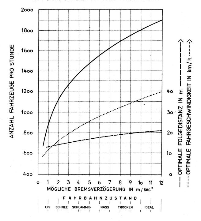
\* DARGESTELLT DURCH DIE MAXIMAL MÖGLICHE BREMSVERZÖGERUNG
