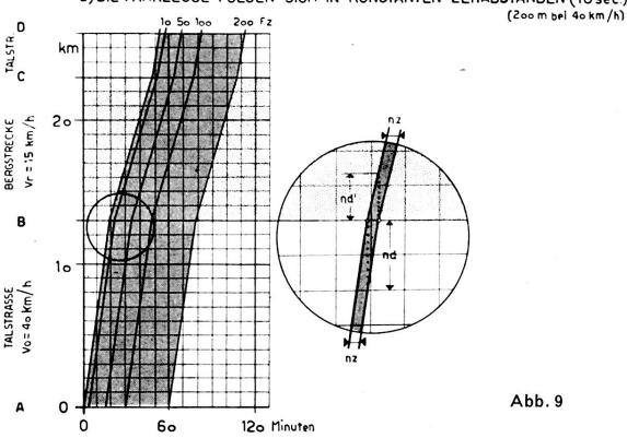
Das Kolonnenende fährt mit der gleichen Geschwindigkeit im konstanten Zeitabstand, was zur Folge hat, daß auf der Hindernisstrecke B-C die Fahrzeugabstände d von  $d_0 = 200 \, \text{m}$  auf  $d_r = d_0 \, \frac{v_r}{v_0} = 75 \, \text{m}$  heruntergesetzt werden.
