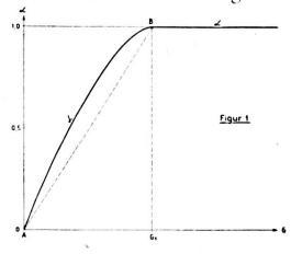
Wir müssen nun versuchen, die Abhängigkeit der Abschußerwartung a vom Geschoßgewicht für eine bestimmte Munitionskonstruktion und für einen bestimmten Flugzeugtyp durch einen Linienzug zur Darstellung zu bringen.
