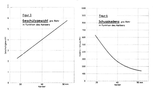
Gewichte, einschließlich Lafetten und Richtmittel enthält. Die Figur 4 enthält diejenigen Kadenzen (Schußfolgen), die bei solcher Konstruktion heute etwa als normal gelten können. Die n-Werte sind aus dieser Kurve entnommen. Endlich wurden als a-Werte diejenigen gewählt, welchen
