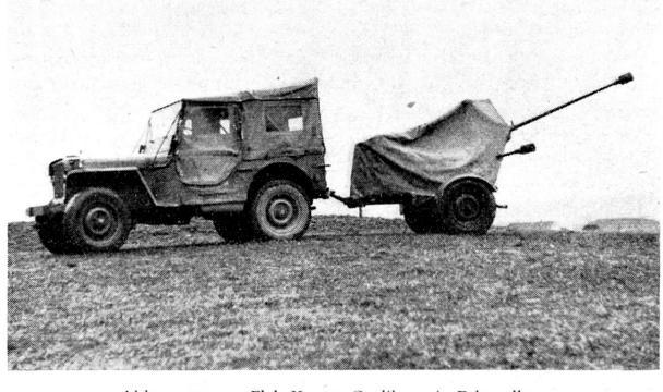
Abb. 3. 20-mm-Flab-K. 54 «Oerlikon» in Fahrstellung mit Geschützblache.
