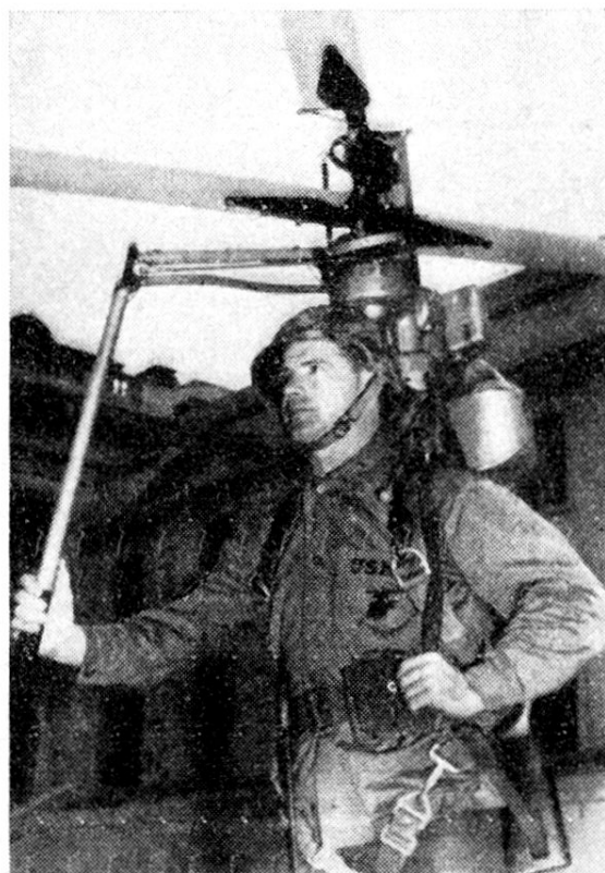
L'hoppicopter: hélicoptère individuel de l'armée américaine. L'ingénieur allemand Weihrauch vient de construire un appareil semblable auquel un moteur de 14CV. donnerait une vitesse de 100 km/h
