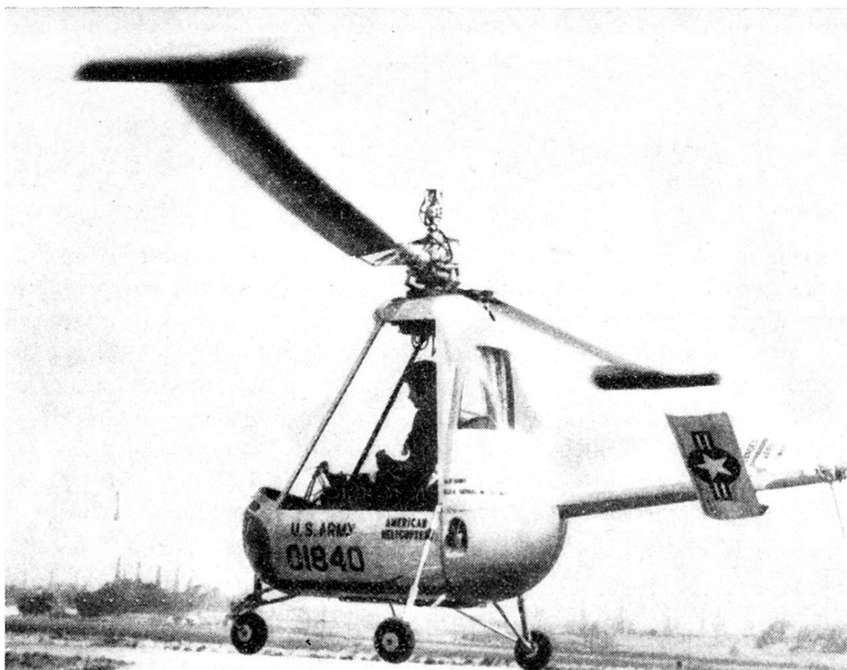
La Jeep volante XH26 Hélicoptère à réaction; à remarquer les pulsoréacteurs au bout des pales du rotor. Le poids de cet appareil est de 130 kg
