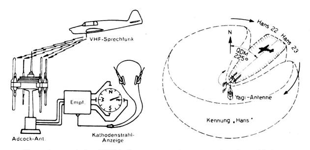
Fig. 4. Automatischer VHF-Peiler
