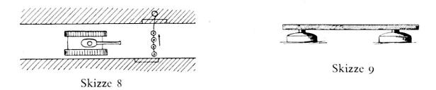
Brettminen. Sie bestehen aus zwei oder mehreren Panzerminen mit Druckzünder in einer Reihe. Über die Zünderköpfe wird ein starkes Brett gelegt, das die Minen zur Detonation bringt, wenn es durch den darüberrollenden Panzer an einer beliebigen Stelle belastet wird. Die Brettminen können verdeckt und offen verlegt werden (siehe Skizze 9).
