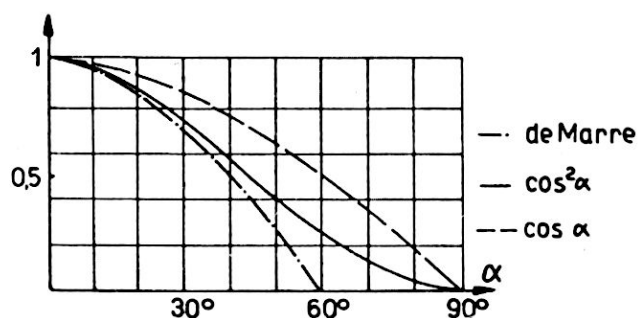
Fig. 3: Reduktion der Durchschlagsleistung bei schrägem Einfall.
