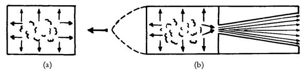
In einem geschlossenen Behälter (a) drückt das darin enthaltene Gas gleichmäßig auf die Wände, der Behälter bleibt in Ruhe. Wird der Behälterraum hingegen durch eine Düse geöffnet (b), so ändert sich die Druckverteilung sofort. Die aus der Düsenöffnung ausströmenden Gase erzeugen an der gegenüberliegenden Seite einen Rückdruck, der eine Vorwärtsbewegung bewirkt. Diese Verhältnisse treffen auf die Rakete zu.
