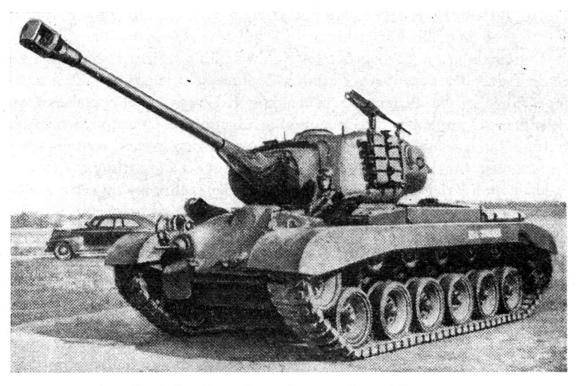
Amerikanischer Panzerkampfwagen «General Patton» M 46 Wasserdicht gelagerter Motor 800 PS, 90-mm-Kanone
