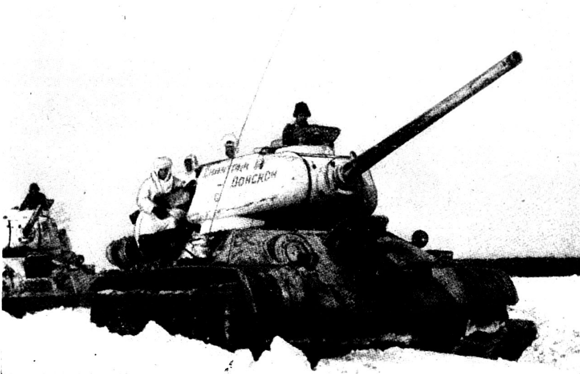
Der russische T-34-Panzerwagen mit der 85-mm-Kanone
