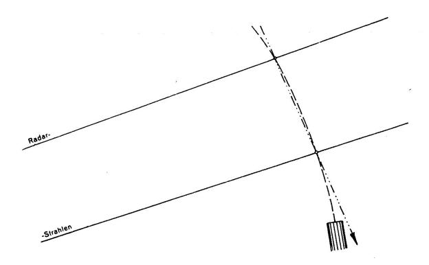
Daraus ergibt sich, daß die Messung umso genauer ist, je tiefer unten der aufsteigende Ast der Flugbahn gemessen werden kann und daß sie umso ungenauer ist, je höher und deshalb gebogener das meßbare Flugbahnstück liegt.
