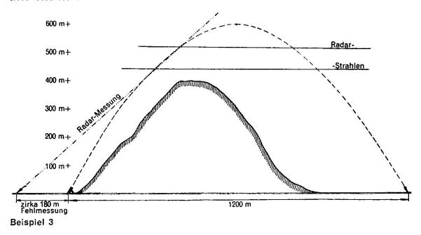
Ein Blick auf die Flugbahnkarten zeigt, daß bei allen Ladungen die kleinen Elevationen steile, die großen Elevationen hingegen flach ansteigende Flugbahnen ergeben. Da die letzteren beim Radar-Mw.-Suchgerät wegen der Krümmung und in Verbindung mit hohen Deckungen Meßungenauigkeiten ergeben, folgt, daß bei allen Schießen nach Möglichkeit mit großen Elevationen und aus Stellungen hinter hohen Deckungen geschossen werden muß.
