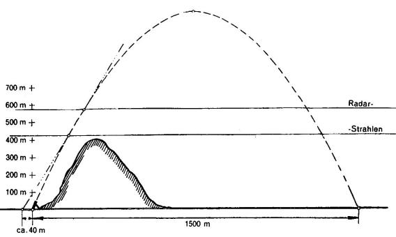
Beispiel 2 Ladung 4 Elevation 35, Decksngshöhe 400 m Mw.-Stellung wird auf zirka 40 m zu weit gemessen
