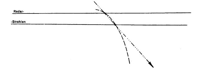
Darin scheint die technische Schwäche des Radar-Mw.-Suchgerätes zu liegen. Hohe Deckungen lassen nur eine Messung der oberen, gekrümmten Flugbahn zu und ergeben somit Ungenauigkeiten. Folgende drei Beispiele mögen das Gesagte deutlicher machen:
