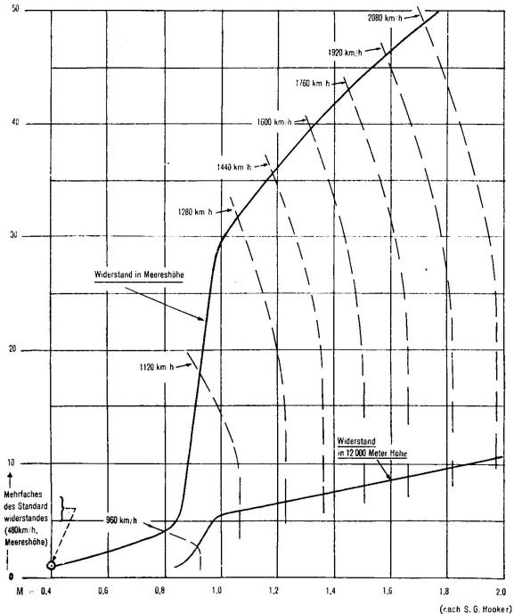
Bild 4 Luftwiderstand bei Überschallgeschwindigkeiten
