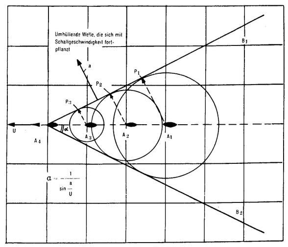
Bild 1 Fliegender Körper mit Überschallgeschwindigkeit
