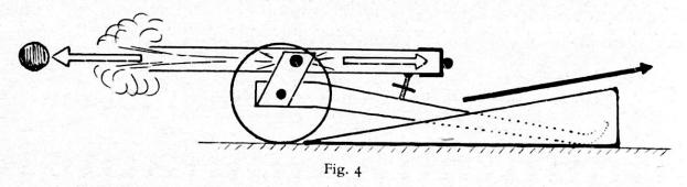
d. Figur 4 zeigt die Urform des Geschützes. Das auf einer Seite hin durch einen Verschluß geschlossene Rohr ist auf einer Lafette festgehalten. Bei der Abgabe eines Schusses wirken wiederum genau die gleichen Kräfte sowohl auf das Geschöß, wie auf das Geschütz. Die auf das Geschütz wirkenden Rückstoßkräfte werden durch Abbremsen der Räder und Auflaufen des Geschützes auf Keile aufgezehrt.
