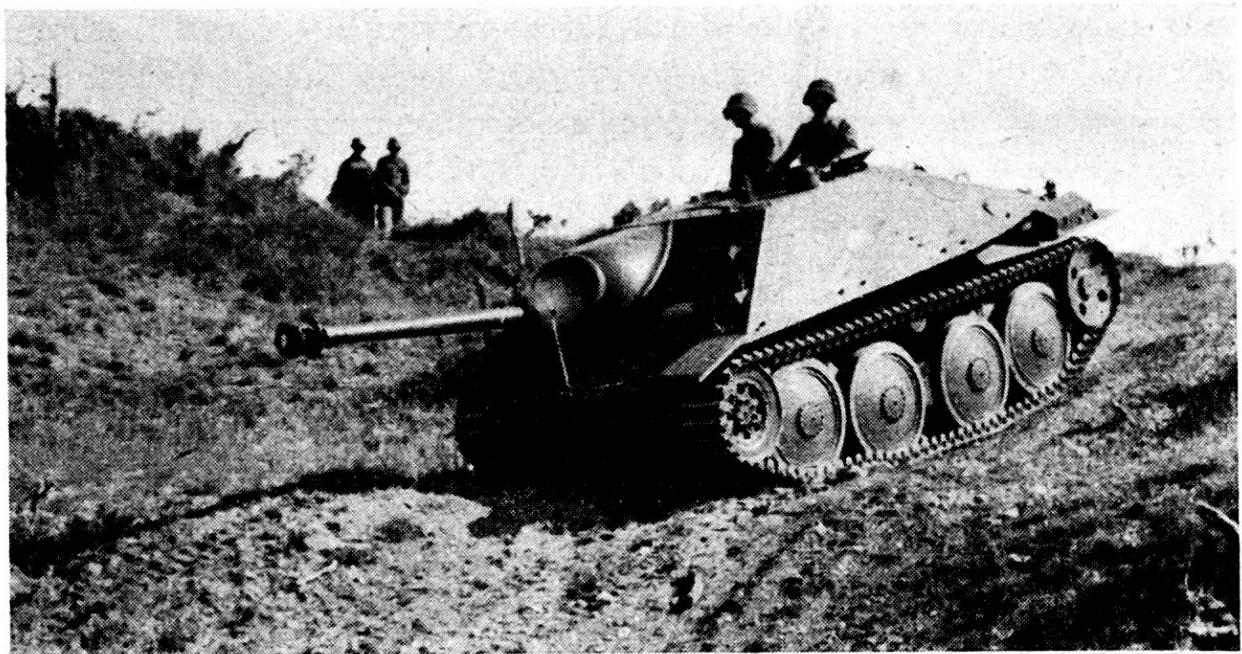
nung – feindliche Kampfwagen aus der Bewegung heraus vernichten kann. In der Bewegung ist der Panzerjäger – wie alle Waffen vom Typ Sturmgeschütz – dem feindlichen Kampfwagen unterlegen, da dieser über einen sehr rasch um 360 Grad drehbaren Turm und eine viel stärkere Panzerung verfügt.
