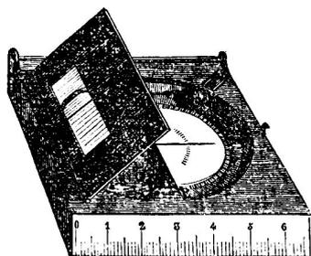
Die Arretirung der Nadel erfolgt durch eine auf dem oberen Rande des hölzernen Gehäuses der Nadel angebrachte Hebelvorrichtung.
