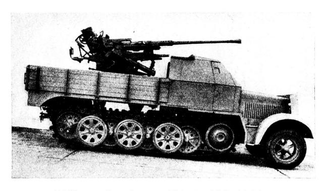
Abbildung 2. Deutsche 3,7 cm Flak 36 auf Selbstfahrlafette. Motor und Fahrergehäuse sind gepanzert.
