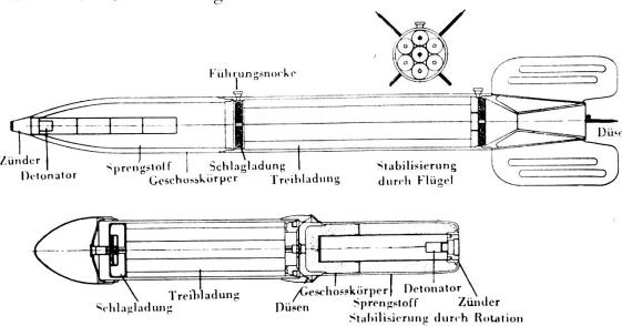
Das Geschoss ist ähnlich dem Artillerie-Geschoss, es kann dünnwandiger als ein Artillerie-Geschoss ausgeführt werden, da die Beanspruchung beim Beschleunigungsstoss geringer ist. Es können deshalb auch Geschosse mit brisanterem Sprengstoff zur Anwendung kommen, selbstverständlich auch spezielle Geschosse wie Brandgeschosse und Hohlladungsgeschosse mit gerichteter Sprengwirkung.
