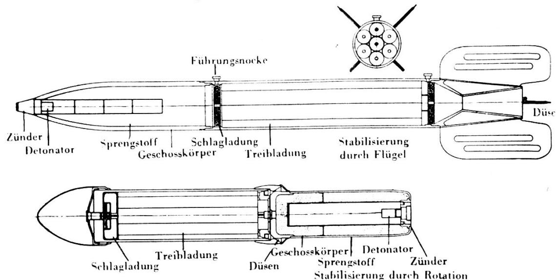
*Das Geschoss* ist ähnlich dem Artillerie-Geschoss, es kann dünnwandiger als ein Artillerie-Geschoss ausgeführt werden, da die Beanspruchung beim Beschleunigungsstoß geringer ist. Es können deshalb auch Geschosse mit brisanterem Sprengstoff zur Anwendung kommen, selbstverständlich auch spezielle Geschosse wie Brandgeschosse und Hohlladungsgeschosse mit gerichteter Sprengwirkung.
