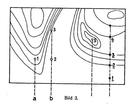
Für das Relief lassen sich beliebige Formen wählen, z. B. eine vorspringende Nase links (Bild 3). Das Ziel sei bei 1, die erste Schussrichtung statt a zu weit rechts in b; dann wird ein Schuss gleicher Distanzzahl nicht in 2 und auf gleicher Höhe wie 1 liegen, sondern es wird bei flacher Bahn das Geschoss weit nach hinten gehen und in 3 aufschlagen. Gibt man sodann kleine Seitenkorrekturen von b nach links, so werden die Aufschläge von 3 bis 1 den Berg hinan sich verschieben.
