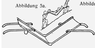
quem in den abgeknickten und eingeschwenkten mit einem Riemen verbundenen vordern Holmen ruht. Die hintern Holme als Kufen umgebogen (Abbildungen 7, 7a).
