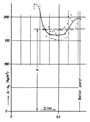
Abb. 2. Zusammenhang zwischen Durchmesser D und Ueberdruck im Balloninnern (Pi—Pa).
