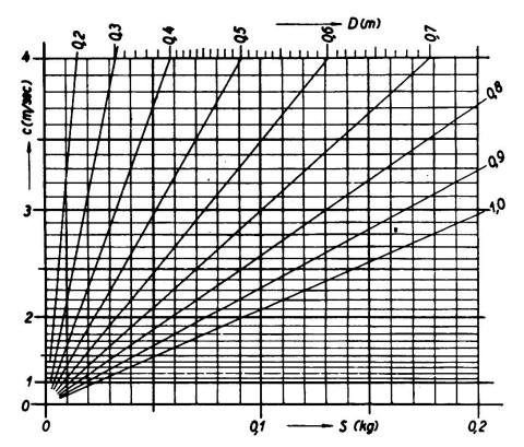
Abb. 1. Steiggeschwindigkeit, abhängig von Steigkraft und Ballondurchmesser für b = 735,5 mm Hg und T = 283 o abs. (10 o C).
