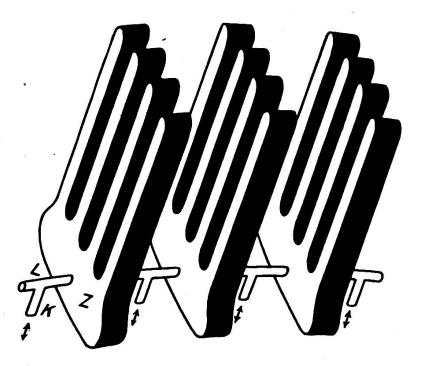
Abb. 2: Gedachter Abguss von drei Hohlraumzellen samt Verbindungskanälen.
