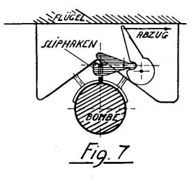
Das Auslösen der Bomben kann entweder mechanisch oder elektrisch geschehen. Bei der mechanischen Auslösevorrichtung wird durch ein Bowdenzug der Sliphaken geöffnet resp. der Exzenterhaken entsichert, währenddem die elektrische Auslösevorrichtung das Oeffnen resp. Entsichern durch eine Stange bewirkt;
