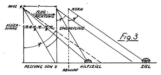
Mit Hilfe einer so konstruierten Visiervorrichtung wird das Ziel auf der Einlauflinie anvisiert und sobald der Vorhaltewinkel  $\varphi$  erreicht ist, die Bombe ausgelöst. Der Vorhaltewinkel ist eine Funktion von H,  $\rho$  und v (Fig. 1). H ist auf dem Höhenmesser abzulesen,  $\rho$  ist aus einer Tabelle für die betreffende Bombe zu entnehmen und v wird mit Hilfe des Visierinstrumentes bestimmt, und zwar durch Messung der Zeit, in welcher ein Hilfsziel Z¹ auf
