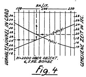
Die Messungen sind nur dann genau, wenn sie möglichst kurz vor dem Ziel durchgeführt werden, wobei Flugweg und Einlauflinie parallel sind und aufs Ziel zeigen, die Achse des Visierinstrumentes im Lot ist, Flugzeuggeschwindigkeit und Flughöhe gleich sind wie im Momente des Bombenabwurfes.
