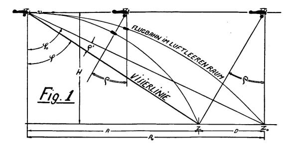
Vorhaltewinkel  $\varphi_{\circ}$  resp. die Wurfweite Ao und damit für die Lage der Visierlinie. Im lufterfüllten Raum bleibt die Bombe infolge des Luftwiderstandes etwas hinter dem Flugzeug zurück. Infolgedessen reduziert sich die Wurfweite Ao um die Distanz D (Rückdrift) und der Visierwinkel  $\varphi_{\circ}$  um einen Winkel  $\rho'$  der proportional dem Rückdriftswinkel  $\rho$  ist. Die Grösse der Rückdrift hängt nur von der Form der Bombe und ihrer Geschwindigkeit gegenüber der Luft ab.
