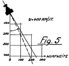
zeuggeschwindigkeit ist, umso mehr nähert sich die Bombenflugbahn dem geradlinigen Flugweg und damit der Ziellinie des Visiers für das Maschinengewehr.
