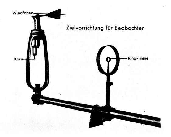
Diese Einwirkung wird durch ein Windfahnenvisier automatisch korrigiert. Durch eine Windfahne wird das Korn, je nach Lage des Gewehres zur Flugrichtung, exzentrisch versetzt.
