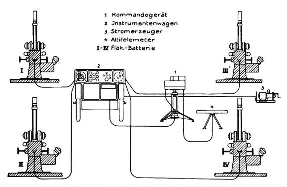
Fig. 6: Schematische Darstellung einer Flak-Batterie mit Zentralkommando-Gerät.
