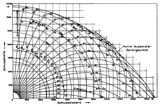
Fig. 2: Flugbahnkarte eines 100 mm Flugabwehrgeschützes.
