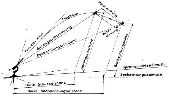
Fig. 1: Beobachtungs- und Schussverhältnisse bei einem Flugabwehrgeschütz (Flak).
