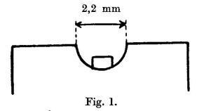
Der Visiereinschnitt besitzt einen Radius von 1,1 mm. Die Länge der Visierlinie (Korn-Visiereinschnitt) beträgt 639 mm. Der Fehlerwinkel der durch den oben angegebenen Zielfehler entsteht ist somit gleich  $0.86^{\circ}/_{00}$   $\left(\frac{1.1}{2}$  mm auf 639 mm =  $0.86^{\circ}/_{00}$ )
