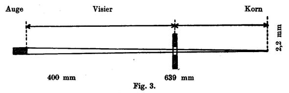
Die Kornbreite beträgt 2,2 mm. Der Abstand des Auges vom Visiereinschnitt wechselt je nach Anschlag. Er beträgt im Mittel ca. 400 mm. Die vom Auge auf den Visiereinschnitt reduzierte Kornbreite (Fig. 3) ist gleich 0,85 mm. Ein Verklemmen in dem oben angegebenen Sinn entspricht somit einem Fehlerwinkel nach der Seite von  $1,06^{\circ}/_{00}$  (0,675 mm auf 639 mm =  $1,06^{\circ}/_{00}$ )
