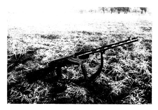
Fig. 2. L. M. G. auf mittlerer Stütze, mit eingesetztem Magazin.
