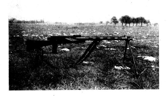
Fig. 1. L. M. G. auf vorderer und hinterer Stütze, mit eingesetztem Magazin.
