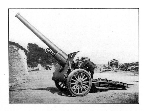
Abb. 2 u. 3 = 150 mm Kanone von Creusot mit Gummirädern. Oben = Geschütz in Stellung in Maximal-Elevation. Unten = Geschütz transportbereit.
