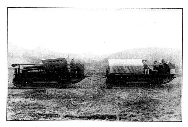
Abb. 13 = Französisches Raupentraktor-Geschütz in Marschformation, an Raupen-Motortraktor angehängt.
