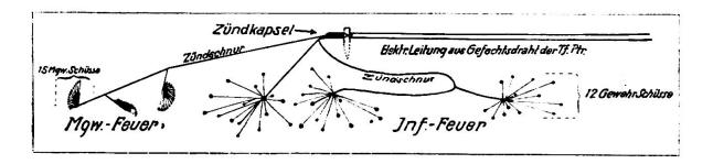
Als elektrische Zündleitung hat sich der Tf.-Gefechtsdraht als vollständig genügend erwiesen. Versuche, die Herr Hauptmann Tschachtli von der Kriegsmaterial-Verwaltung damit angestellt hat, haben ergeben, daß auf 1000 m Länge, selbst bei nassem Boden, die Sprengkapseln durch die bei den Sappeur-Kpn. im Gebrauch stehenden Minenzündapparate zuverlässig gesprengt werden können.
