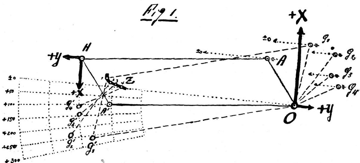
zu den markierten Punkten. Sodann legt man den Kreuzungspunkt  $O$  der Achsen der um  $3200 A^{\circ}/\text{oo}$  gedrehten Pause zunächst auf  $Z_1$  und der Geschützpunkt  $G_1$  zeigt in  $G_1$ <sup>1)</sup> im Netz Richtung und Distanz für Geschütz  $G_1$  an; man schiebt dann den Achsenkreuzpunkt  $O$  der Pause auf den für  $G_2$  gewollten Treffpunkt  $Z_2$  und der Geschützpunkt  $G_2$  zeigt im Netz Richtung und Distanz für Geschütz  $G_2$  an usw.
