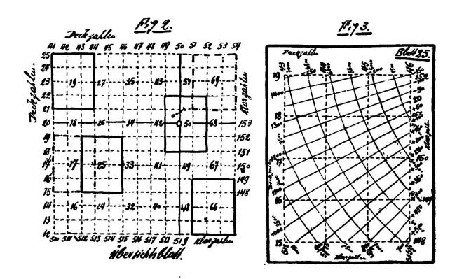
Wenn man sich den Schießplan selber herstellt, verwendet man am einfachsten gewöhnliches Millimeterpapier und arbeitet dann im Maßstab 1:20000. Der Maßstab ist selbstverständlich gleichgültig unter der Bedingung, daß Batteriekroki und Zielkroki im selben Maßstab gehalten sind.
