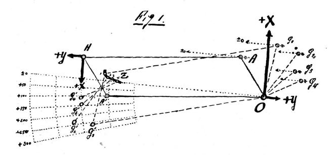
zu den markierten Punkten. Sodann legt man den Kreuzungspunkt O der Achsen der um 3200 A<sup>0</sup>/<sub>00</sub> gedrehten Pause zunächst auf Z1 und der Geschützpunkt G1 zeigt in G11 im Netz Richtung und Distanz für Geschütz G1 an; man schiebt dann den Achsenkreuzpunkt O der Pause auf den für G2 gewollten Treffpunkt Z2 und der Geschützpunkt G2 zeigt im Netz Richtung und Distanz für Geschütz G2 an usw.
