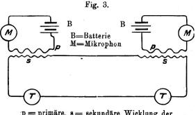
p = primäre, s = sekundäre Wicklung der Induktionsspuhle.
