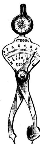
speziell für top. Karten in den Massstäben von 1 : 100,000 und 1 : 25,000, auch als Millimeter-Masstab sowie Greif- und Spitzzirkel verwendbar. Sehr praktisch und bewährt! Mod. 1, bis 6 Kilom. bzw. 6 cm messend, Fr. 2 per Stück. Mod. 2, bis 8 Kilom. bzw. 8 cm messend, Fr. 2. 20 per Stück; mit Kompass versehen 50 Cts. Zuschlag. Zu beziehen durch den Alleinfabrikanten
