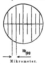
Die Mikrometerplatte ist demzufolge durch eine Anzahl Striche derart eingeteilt, dass der Abstand zwischen zwei auf einander folgenden Strichen einem Seitenfehler von 10 Meter pro Kilometer entspricht oder, was das Gleiche ist, 10 Graden des Schiebvisiers.
