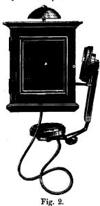
Fig. 2 zeigt die Kombination einer Wandstation mit transportablem Apparat für den Privat-Gebrauch. In dem einfachen Holzgehäuse befindet sich nur der Taster, die Induktions-Rolle, der Wecker, der Blitzfänger und der automatische Umschalter.
