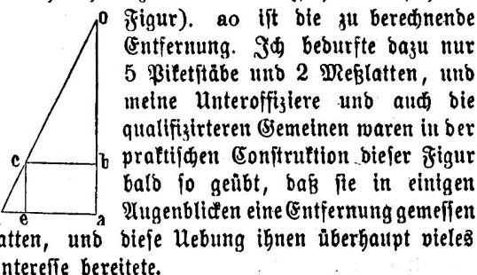
Figur). so ist die zu berechnende Entfernung. Ich bedurfte dazu nur 5 Picketstäbe und 2 Meßplatten, und meine Unteroffiziere und auch die qualifizirteren Gemeinen waren in der praktischen Construktion dieser Figur bald so geübt, daß sie in einigen Augenblicken eine Entfernung gemessen hatten, und diese Übung ihnen überhaupt vieles Interesse bereitete.
