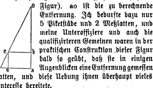
Figur). so ist die zu berechnende Entfernung. Ich bedurfte dazu nur 5 Pikenstäbe und 2 Meßplatten, und meine Unteroffiziere und auch die qualifizirteren Gemeinen waren in der praktischen Construktion dieser Figur bald so geübt, daß sie in einigen Augenblicken eine Entfernung gemessen hatten, und diese Übung ihnen überhaupt vieles Interesse bereitete.
