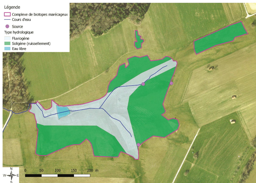
Fig. 4. Le marais présente un fonctionnement hydrologique mixte : fluviogène dans l'emprise historique des cours d'eau (en bleu clair) et soligène de ruissellement dans le reste du biotope (vert). Les cours d'eau dépendent des sources et doivent pouvoir divaguer librement dans le terrain alors que les surfaces de marais de pente nécessitent un ruissellement diffus.
