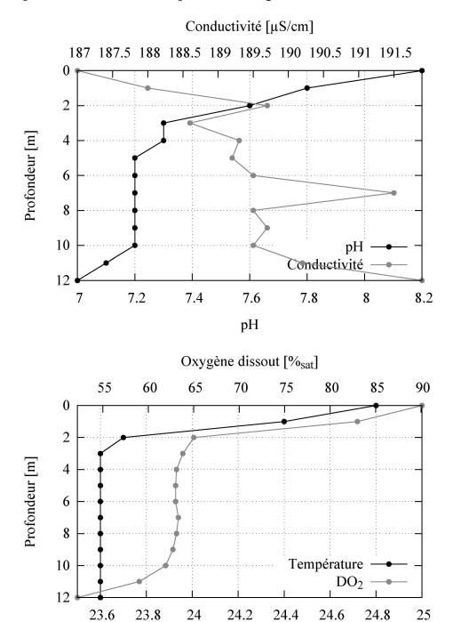
Fig. 2: Profil de diverses variables en fonction de la profondeur pour le site 1 (Barrage). Notons que les axes x et y sont échangés et que l'échelle y est inversée. À gauche : température et oxygène dissout. À droite : conductivité et pH.
