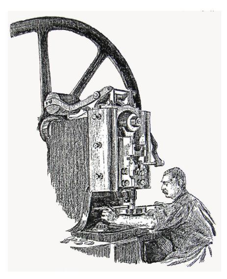
Fig. 2 : Découpage à la poinçonneuse
