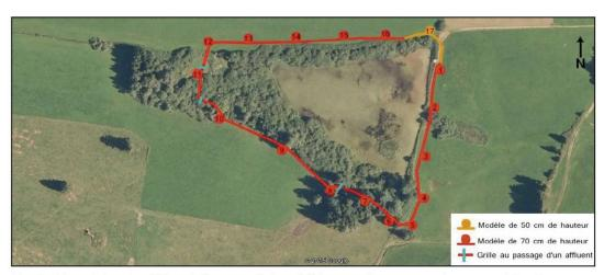
Fig. 3: Répartition des 600 m de barrages à Amphibiens sur le pourtour du secteur Noz. Les seaux sont numérotés de 1 à 17. Source: Google Earth.
