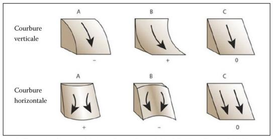
Fig. 9: Illustration des caractéristiques des courbures (adapté de: Kimerling et al. 2012).
