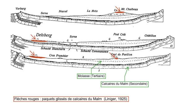
Fig. 6: Profils géologiques nord-sud établis par Liniger (1930); en rouge, les masses glissées.
