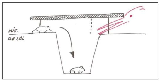
Fig. 4: Plaque de protection contre les prédateurs. En rouge: le prédateur potentiel observé le plus fréquemment sur le site, le Héron cendré Ardea cinerea. Schéma: Gauvain Saucy.
