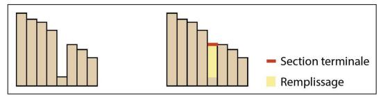
Fig. 8: Illustration en 2D du fonctionnement de l'outil remplissage (ArcGIS, 2010).
