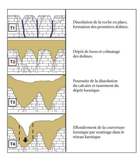
Fig. 4: Schéma d'évolution morphologique possible de dolines.
