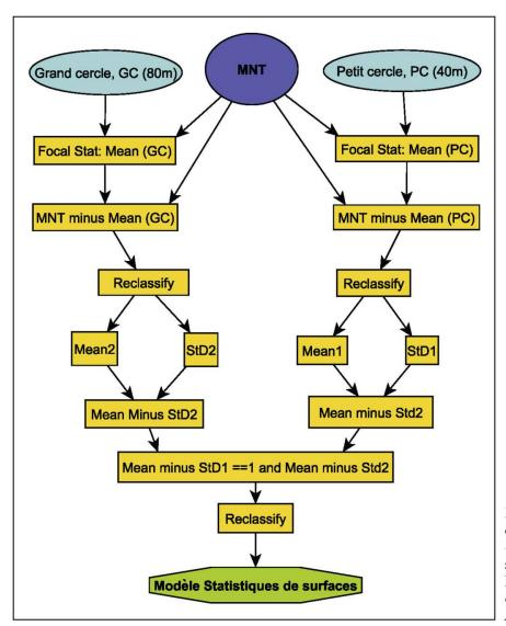
Fig. 10: Schéma de la méthode « statistiques de surfaces » avec les noms des outils dans *ArcMap*.
