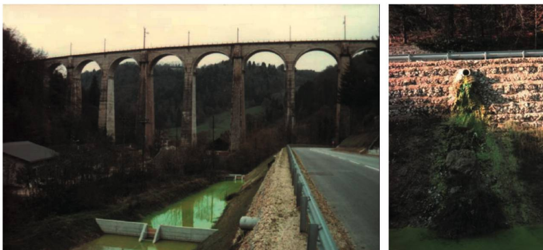
Fig. 14: Essai de coloration du 7 novembre 1995 et réapparition du traceur fluorescéine 2 h après l'injection.
