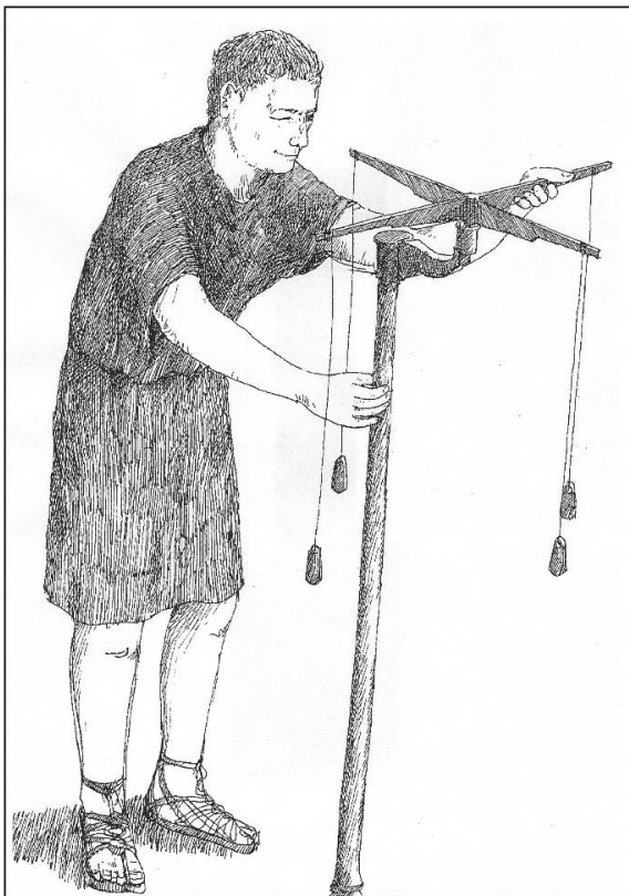
Fig. 1 : La groma. La groma consistait en une perche d'environ 1,2 m sur laquelle une croix était fixée horizontalement. A chaque extrémité de la croix pendait un fil à plomb. Quand les quatre fils étaient parallèles à la perche, la groma était bien verticale et l'on pouvait alors déterminer des directions perpendiculaires entre elles.
