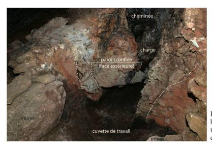
Fig. 25. Vue frontale du bas fourneau : en pointillés, les parties friables de la paroi.
