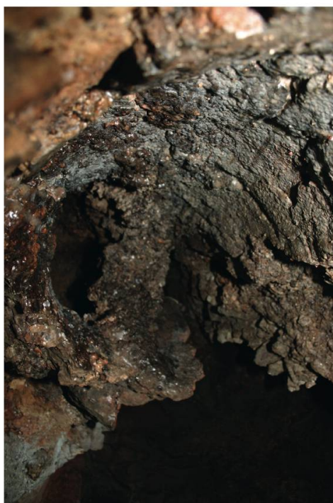
Fig. 21. Vue sommitale de la dernière charge bloquée dans la cheminée du bas fourneau.
