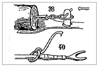
Fig. 32. Outils en lien avec le débardage (« 38 : chaîne à coin et patin pour traînage ; 40 : griffes »).
