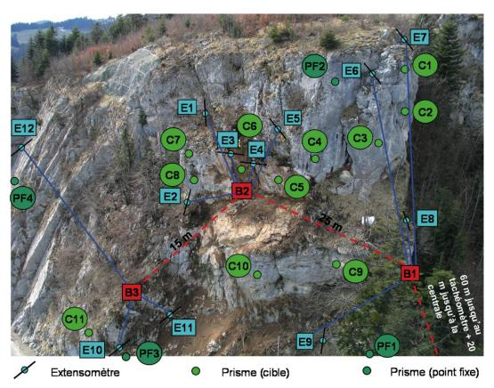
Figure 11 : réseau de surveillance de la falaise.
