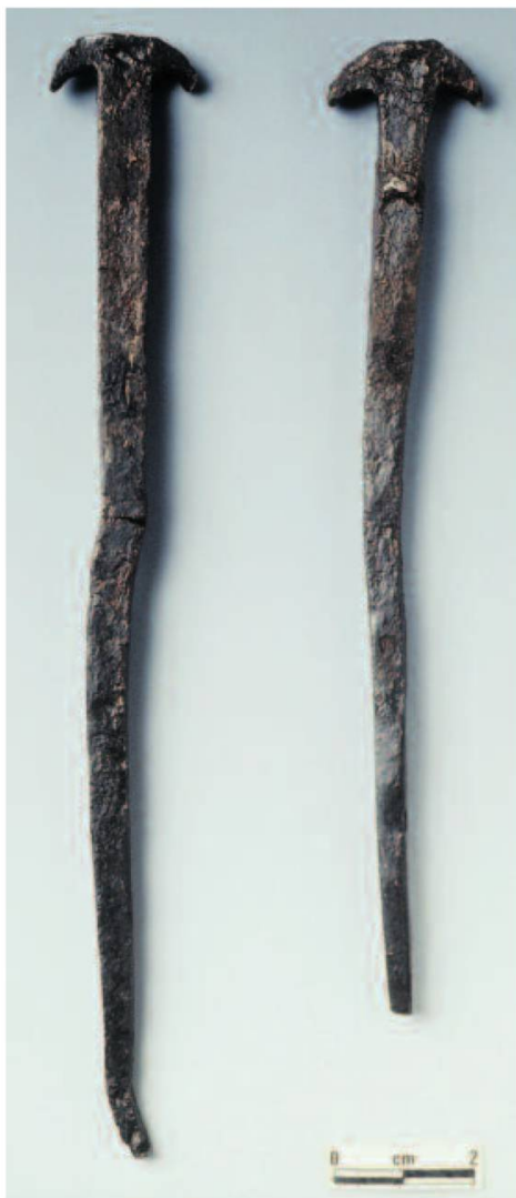
Fig. 9: Deux clous ayant servi à l'assemblage du tronçon étanche. Photo B. Migy
