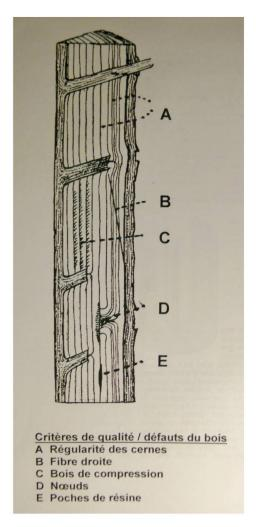
Schéma des défauts du bois. Dans la nature, les «défauts» du bois sont la norme: bois noueux, fibre torse, poches de résine, irrégularité de croissance, bois de réaction... cela explique la rareté du bois de résonance, qui doit être exempt de ces défauts. Source: Dessin, Nikola Zaric.
