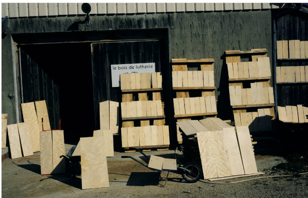
Les facteurs d'instruments achètent leur matière première bois sous forme de planchettes de diverses dimensions (photos: doubles planchettes d'épicéa pour table de violon (en haut) et d'érable ondé mises à «bronzer» devant l'atelier de Bois de Lutherie (Fertans/F). Photos: Ph. Domont.
