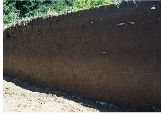
ou du Fer). Lumière naturelle. Hauteur réelle de la photo: 1,45 mm. Photo D. Aubry. Fig. 26: Profil de sol agricole, vallée sèche, lieu-dit «Combe de Va Tche Tcha», commune de Courtedoux. Les cultures se développent sur une couche de colluvions anthropogènes d'environ 80 cm d'épaisseur qui reposent directement sur le substratum calcaire du Kiméridgien. Photo D. Aubry.
