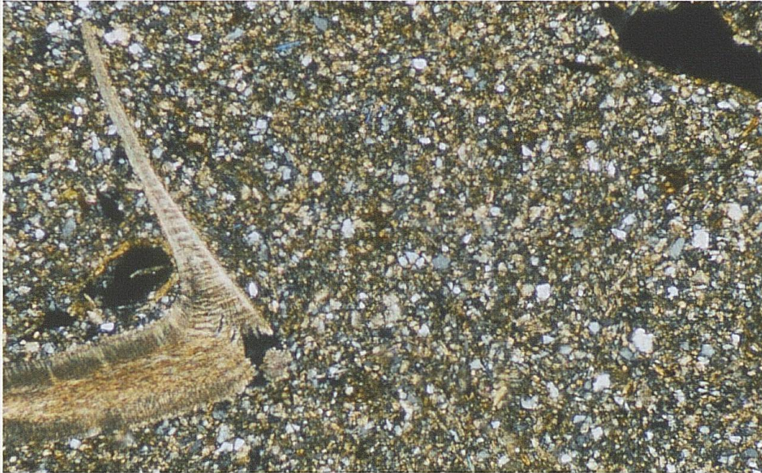
Fig. 7: Vue au microscope des lœss du Pléniglaciaire supérieur (unité E6, Alle - Noir Bois). Ces dépôts sont formés de grains bien triés de quartz, mica et calcite d'une taille de 20 microns. A gauche, une coquille de mollusque. Lumière polarisée, hauteur réelle: 1,5 mm (photo M. Guélat).
