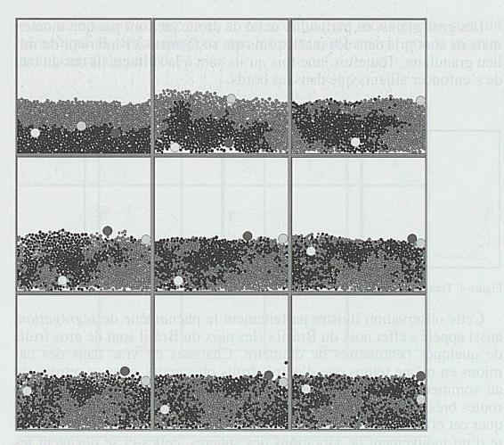
Figure 2. Evolution du milieu sous l'effet de vibrations verticales.
